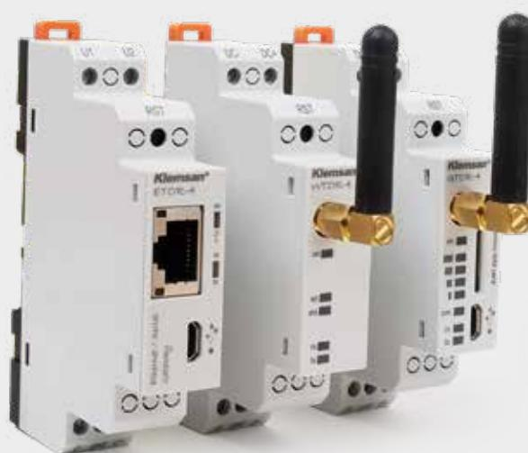
ETOR-4 ve ETOR-2 ürünlerinin yenilenen arayüz programı ve yazılımı ile MODBUS protokolü doğrulaması opsyonel olacak şekilde eklenmiştir. Bu opsion ile ETOR ürünleri, mevcut sistemin sahip olduğu haberleşme protokolü ile veri alış verişini gerçekleştirir.
