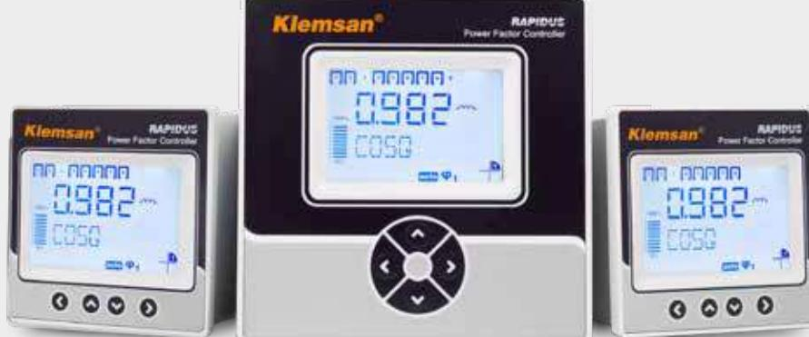
RAPIDUS 1 serisi, çok fonksiyonlu bir fazlı reaktif güç kontrol rölesiidir. Bağlı olduğu sistemin aktif ve reaktif güçlerini ölçmektedir. Bu ölçümeler sonucunda; kompanzasyon panosunda bulunan kondansatörleri devreye alır. Ön panelde bulunan LCD ekran ve 4 adet tuş ile tüm kullanıcı işlemleri kolaylıkla yapılır. RAPIDUS'ta, izole RS485 portu bulunmaktadır. 2 adet alarm rölesi ve daha bir çok özelliğe sahiptir.
