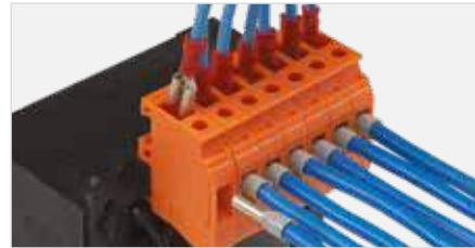
TRV serisi trafo klemensleri Alçak Gerilim trafo imalatında ihtiyaç duyulan tip ve kesitlerde kullanıma sunulmuştur. TRV 4 ürünü fast-on kablo başlığı ile de kullanıma olanak sağlamaktadır. TRV S sigortalı klemenslerde ise 5x20 mm ölçüsünde cam sigorta kullanılmaktadır. Plotter ile markalamayı kolaylaştıracak aksesuarları mevcuttur.
